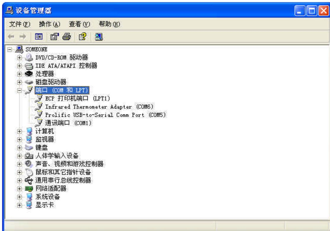
我们会看到系统多了一个叫“ Infrared Thermometer Adapter ”的端口, 后面是端口号。到此, USB Cable 的驱动安装完毕。
